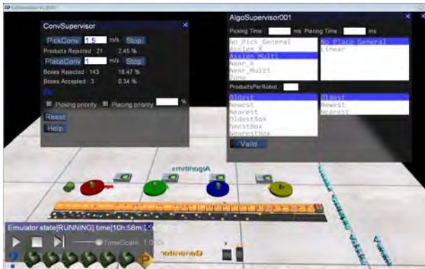
Fig. 4 Exemple de simulation avec quatre robots et deux convoyeurs co-courant avec la stratégie de collaboration DownToUp
