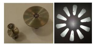
Fig.3. a) Disques fabriqués pour essais de débit et banc de frottement. b) Détail des fentes usinées.
