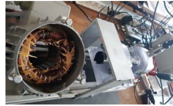
Surveillance et vieillissement accéléré d'actionneurs
