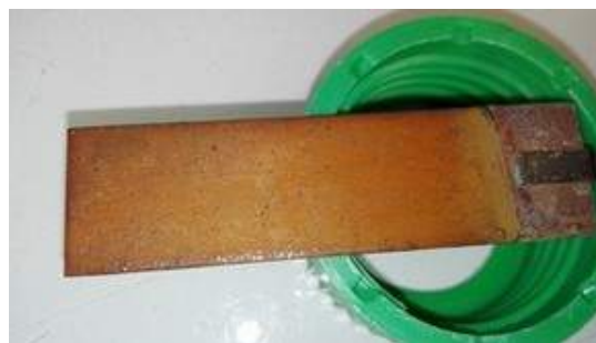
FIGURE B.3 – Anode en cuivre après expérience, pas de biofilm
