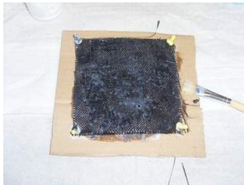
FIGURE 5.7 – Application de la couche de PTFE pour imperméabiliser le tissu.
