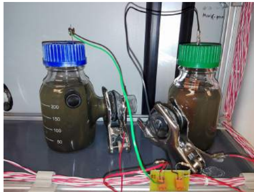
FIGURE 3.1 – Les deux piles utilisées au cours de l'expérience de test d'anode
