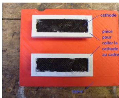
FIGURE 5.8 – La cathode assemblée de la première pile
