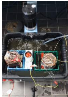
FIGURE 6.11 – Essais avec injection d'air dans les effluents
