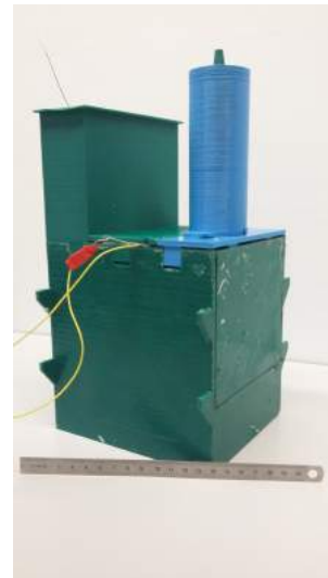
FIGURE 5.12 – Pile verte après un séjour de 2 semaines dans les effluents (le réglet mesure 20cm)
