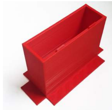
FIGURE 5.3 – Cheminée équipée de sa jupe d'impression pour éviter le décollement
