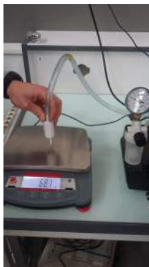
FIGURE 4.4 – Test d'un vérin d'essai grâce à un compresseur et une balance
