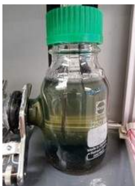
FIGURE B.4 – Pile avec anode en cuivre après expérience
