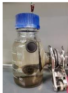
FIGURE B.5 – Pile avec anode en tissu de carbone après expérience
