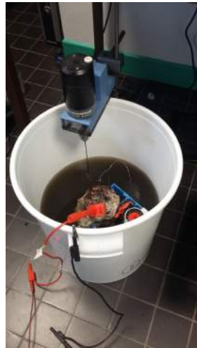
FIGURE 6.1 – Bassin d'essai avec agitateur
