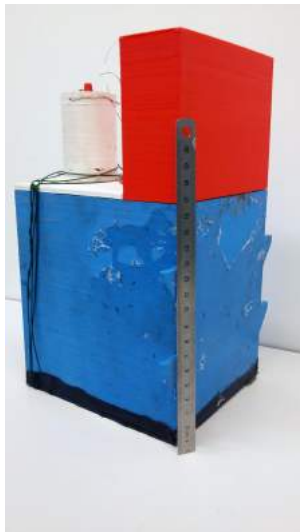
FIGURE 5.11 – Pile bleue après un séjour de 2 semaines dans les effluents (le réglet mesure 20cm)
