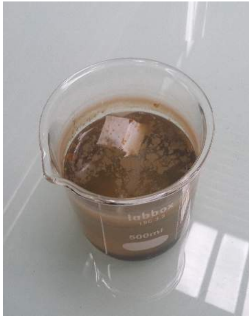
FIGURE 4.1 – Cube de test du PLA dans des effluents
